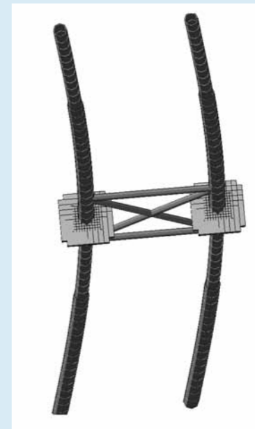
Рис. 13. Общий вид расчетной модели телескопических стоек-домкратов с фланцевым соединением, соединенных связями из трубы 25x2.5
